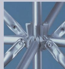
Das Ergebnis überlegener Konstruktion. Bis zu 8 Anschlüsse lassen sich im statisch idealen Allround-Knoten auf einer Ebene in verschiedenen Winkeln anschlagen. Anschlagmöglichkeiten sind im Rastermaß von 50 cm an allen Allround-Stielen vorgesehen. Die flache Lochscheibe verhindert ein Zusetzen mit Schmutz aller Art.
