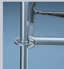
Ein Hammerschlag auf den Keil verwandelt den Formschluss in den unübertroffenen Kraftschluss. Die Stirnseite des Keilkopfes liegt jetzt exakt am Stiel an.
