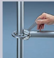
Das AllroundGerüst weist eine einfache, einzigartige und schraubenlose Verbindungstechnik auf. Keilkopf über die Lochscheibe schieben und Keil einsetzen, schon ist das Bauteil gegen Herausfallen und Verschieben gesichert. Zum Befestigen des anderen Riegelendes ist noch genügend Spiel vorhanden.
